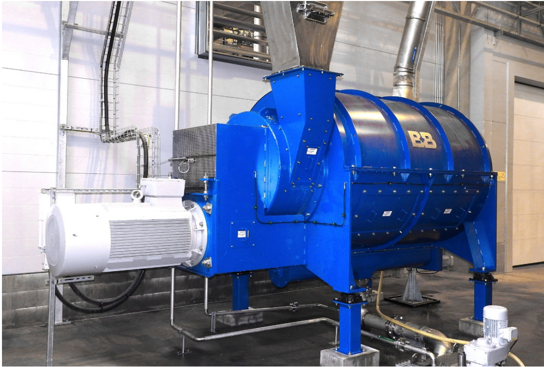
Hình 3.29. Ảnh máy tách nước cơ học (Centrifuge) / Công ty B+B
