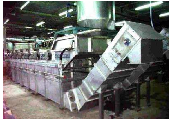
Hình 3.23. Bể tách Chìm/Nổi trong chuyên tái chế chai PET (Courtesy of OCI GmbH)
