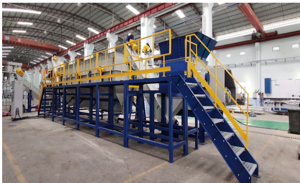
Hình 3.19. Hình máy rửa sơ bộ (Sink-Float Tank)
