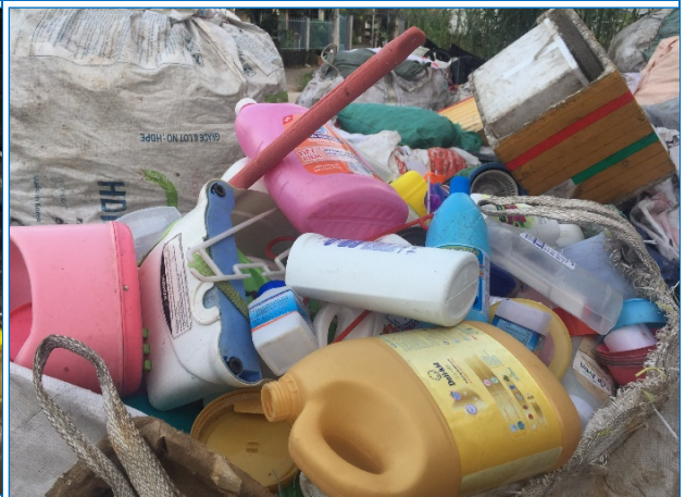
Nhựa màu các loại được phân loại sơ bộ tại cửa hàng ve chai (HDPE, LDPE, PP,...)
