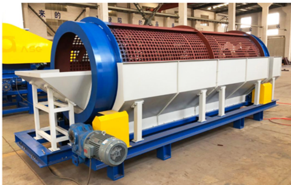
Hình 3.20. Hình máy rửa sơ bộ dạng trống quay (Pre-Wash-Drum)
