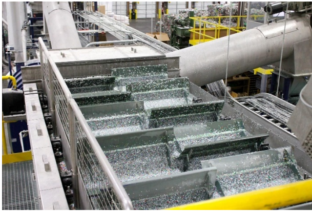
Hình 3.22. Bể tách Chìm/Nổi (Nguồn: https://www.bub-anlagenbau.de/products/ )
