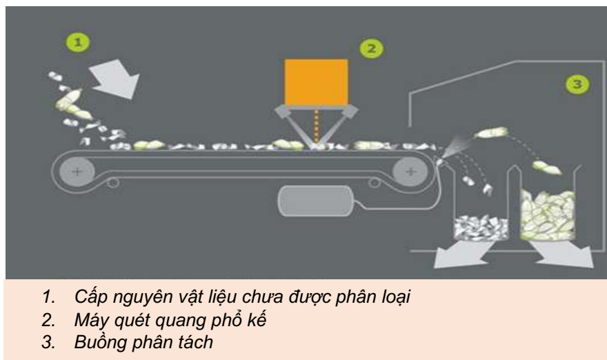
Hình 3.12. Nguyên tắc hoạt động máy phân loại cận hồng ngoại (NIR).
